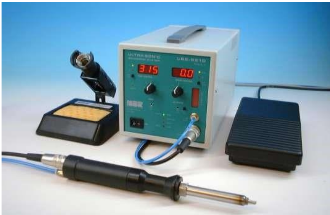
Настольная паяльная станция USS-9210MkII Паяльник с мощностью ультразвука 15Вт и принудительной конвекцией (обдув горячим воздухом)
