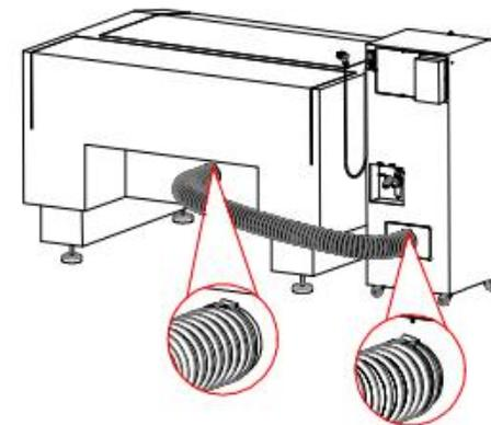
Соедините дымоуловитель с лазерным гревером гибким воздуховодом. Зафиксируйте воздуховод хомутами, чтобы не было утечки воздуха.
