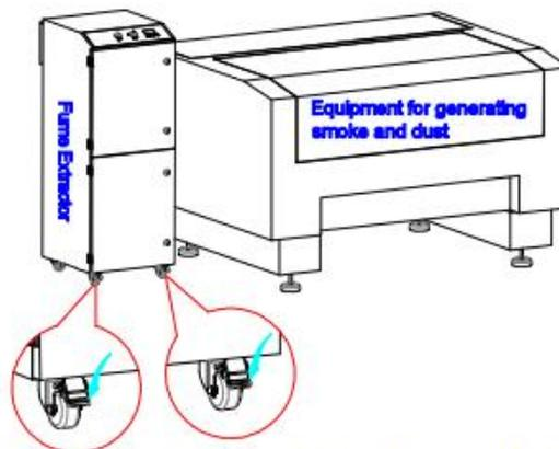
Распакуйте и установите дымоуловитель на место, где он будет работать рядом с лазерным станком. Нажмите ногой на фиксаторы колёсиков, чтобы застопорить их.
