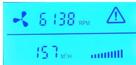
При обнаружении засорения фильтрующего элемента в правом верхнем углу дисплея появятся треугольник и восклицательный знак, а также раздастся звуковой сигнал. Линия "Сигнал тревоги блока фильтра" выходного порта выдает напряжение 12 В постоянного тока, и в сочетании с линией "Общая клемма" может быть получен выходной сигнал напряжения 12 В постоянного тока. Когда машина работает в обычном режиме, эта группа линий не имеет выходного напряжения.
