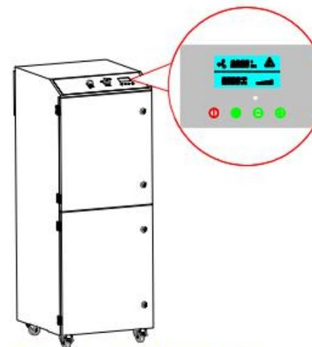
Нажмите на красную кнопку, вытяжка начнет работать. Используйте кнопки + и -, чтобы настроить воздушный поток.
