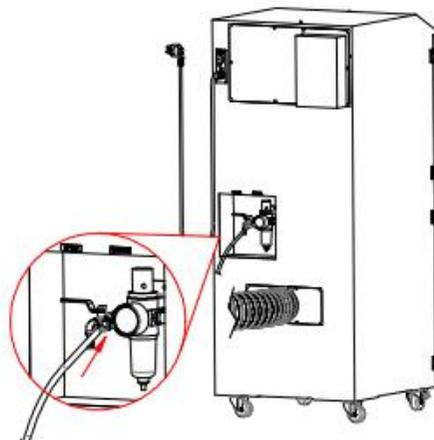
Подсоедините шланг компрессора к порту на регуляторе давления. Давление установите на 5 Бар. Закройте кран сброса давления.
