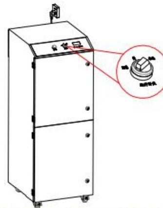
После подключения кабеля питания к электророзетке поверните переключатель режима работы на Local. На панели управления замигает красная кнопка. Для удаленного запуска машины установите в Remote и подайте 24 В на сигнальный кабель.
