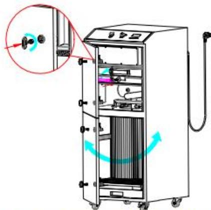
Откройте дверцу блока при помощи ключа из аксессуаров на в задней части блока. Извлеките транспортировочные элементы и аксессуары из отсека фильтров. Используя шестигранный ключ, поверните винт фиксатора на 90 градусов по часовой стрелке так, чтобы фильтр плотно прижался.
