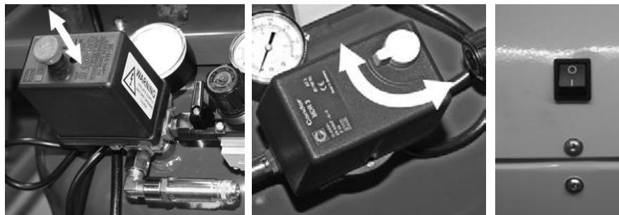
Компрессор включается при помощи красной кнопки в верхней части реле давления. Потяните ручку вверх, чтобы включить или надавите вниз, чтобы отключить питание компрессора. Кнопка включения может отличаться у разных моделей.
