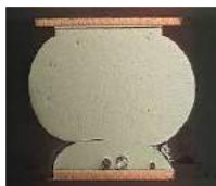
Дефект "Голова на подушке"
