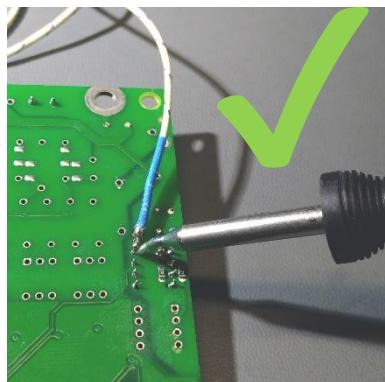
В случае, если измерения все-таки показали превышение допустимой температуры, что возможно на очень тонких и легких платах, нужно заменить индукционный наконечник на более низкотемпературную серию.
