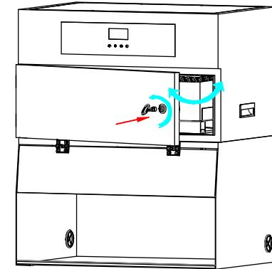
Распакуйте и установите дымоуловитель на место, где он будет работать. Проверьте корпус и смотровой щиток на повреждения.
