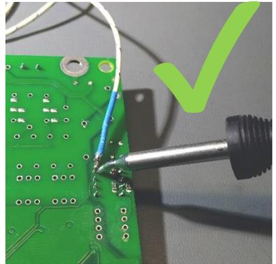
В случае, если измерения все-таки показали превышение допустимой температуры, что возможно на очень тонких и легких платах, нужно заменить индукционный наконечник на более низкотемпературную серию.
